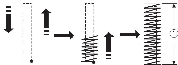
Riegel dienen z. B. zum Verstärken von Taschen, Schrittnähten und Gürtelschlaufen.
