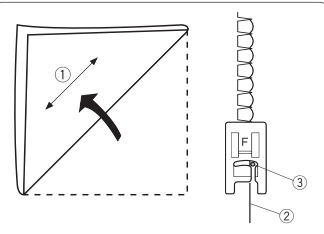
Benutzen Sie einen feinen Stoff (wie z.B. Trikot). Falten Sie den Stoff wie abgebildet diagonal, und nähen Sie über die Faltkante.
