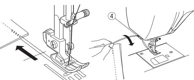
Verwenden Sie den Fadenabschneider am Kopfdeckel, um Spezialfäden oder dicke Fäden (#30 oder dicker) abzuschneiden.
