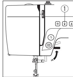
Relevez le pied-de-biche. Appuyez sur la touche position d'aiguille haute/basse ① pour relever le levier de fil au maximum.
